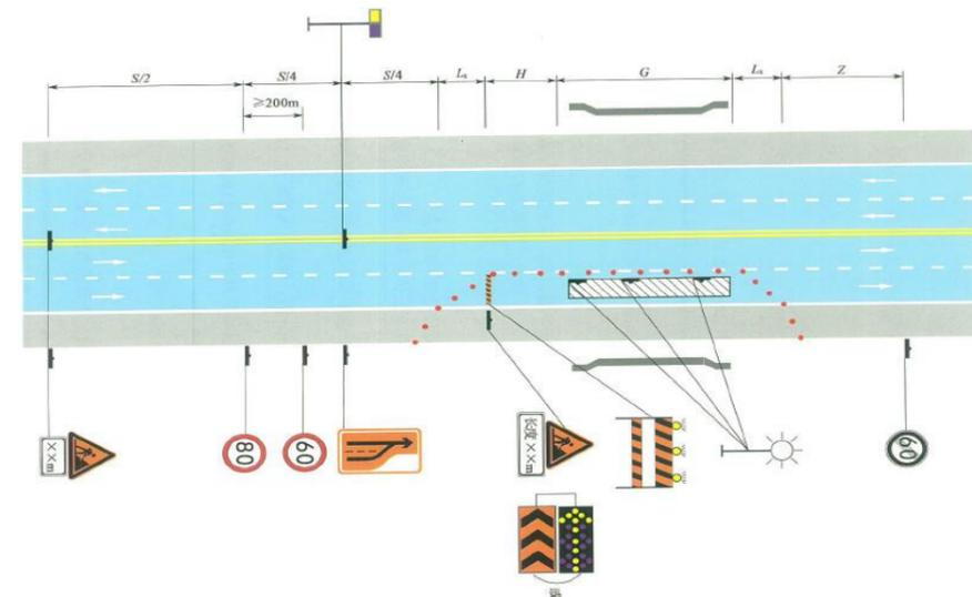
图 8-1 中、小桥桥面封闭车道养护作业
