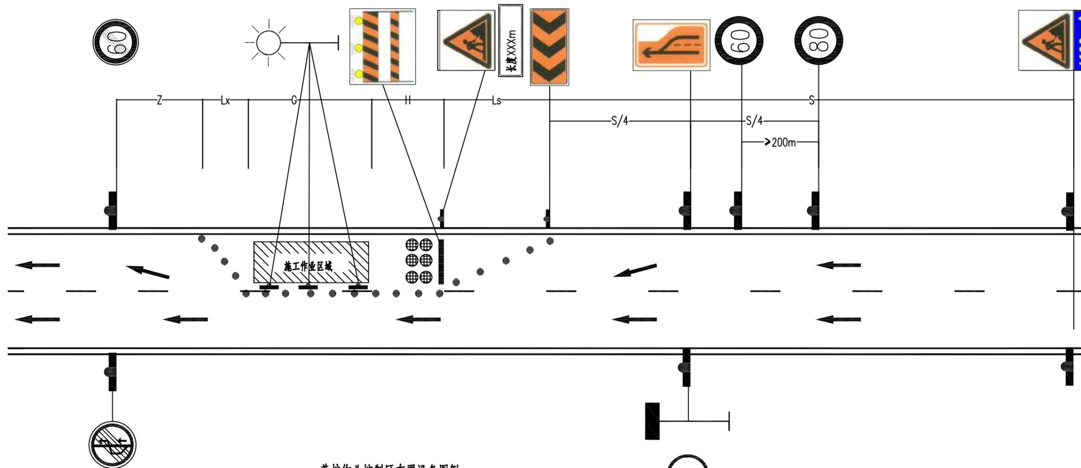
养护作业控制区布置设备图例
