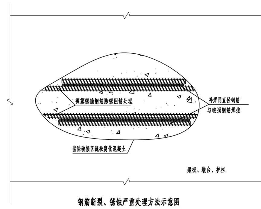
钢筋断裂、锈蚀严重处理方法示意图
