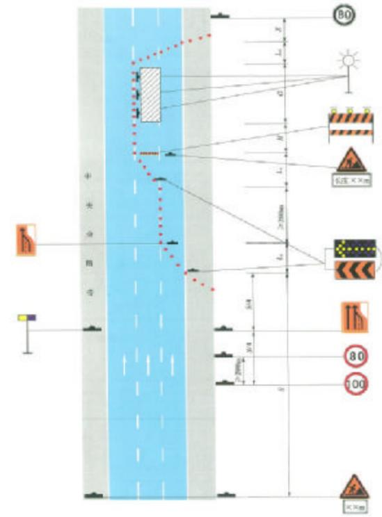
图 11 六车道封闭外侧车道
