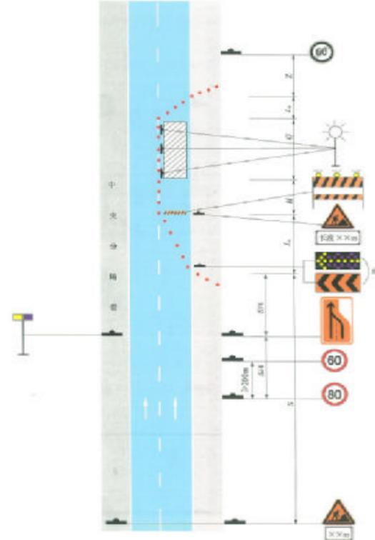
图 8 四车道封闭外侧车道
