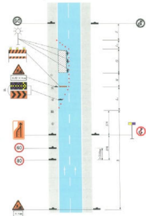
图 7 四车道封闭内侧车道
