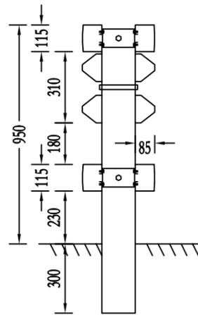
过渡板连接立柱图 (二波端头)
